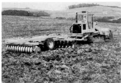
第8図 大型ディスクハローによる 耕起作業
