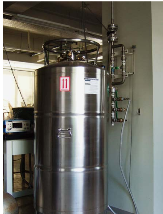
図6. 100 l 液体ヘリウム容器と回収配管
