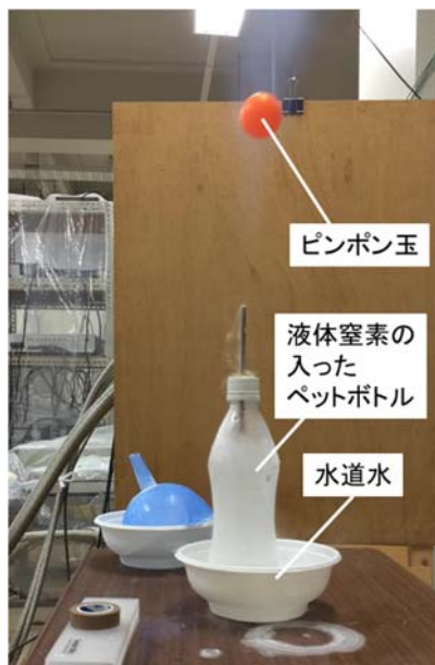
図 1. 液体窒素を使ったピンポン玉の空中浮揚実験.
