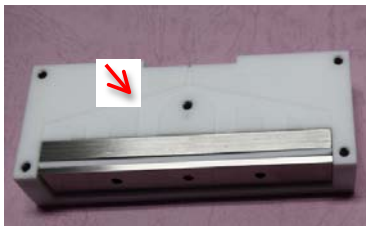
図3 スリットノズル。ガス導入用の溝を矢印で記した
