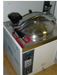
加熱した脱パラ染色瓶列 専用オートクレーブ
