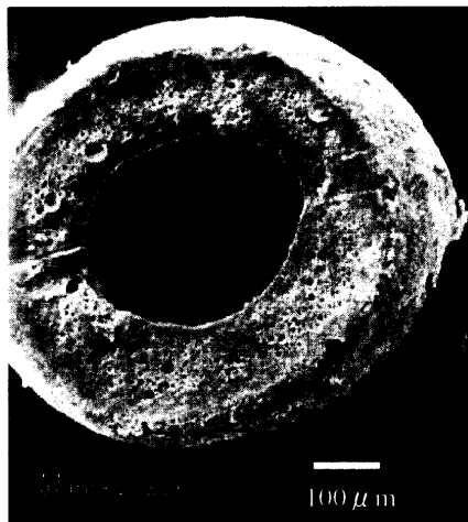
図 6 脱窒細菌を固定化したコア/シェル型ポリスチレンマイクロカプセルの SEM 写真
