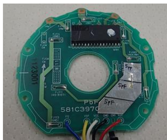
図 2.35 調整用コンデンサ C_{adj} の静電容量の調整方法の実施例
