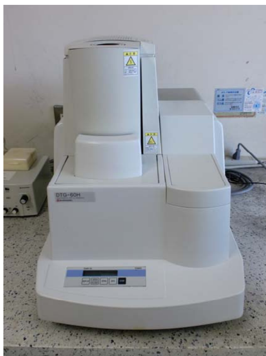
写真-3.3 TG/DTA 同時測定装置
