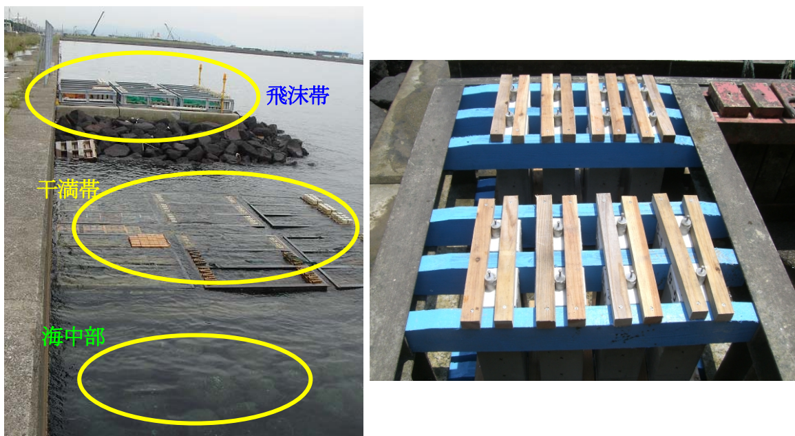
写真-5.1 谷山港内海洋曝露場と供試体の設置状況
