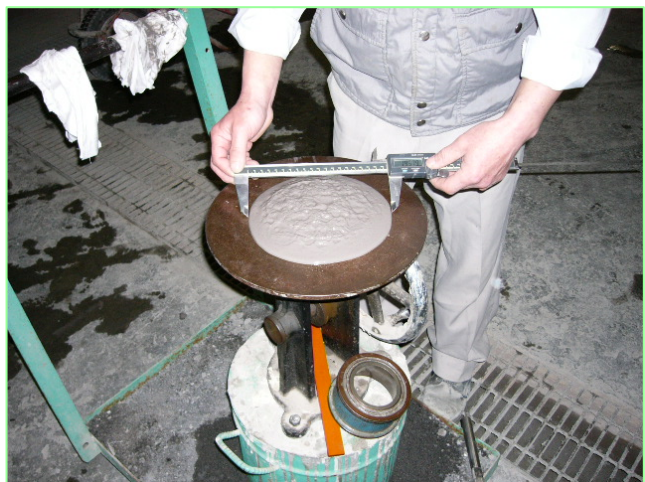
写真-3.1 フロー試験状況
