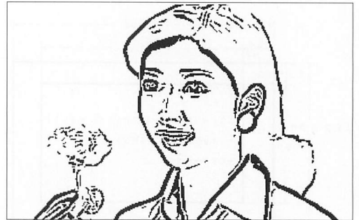
図9. ソーベルフィルタによるエッジ検出の例
