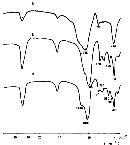
図2 シラスおよび標準X型, Y型ゼオライトの赤外線吸収スペクトル A: シラス B: 標準のX型 C: 標準のY型
