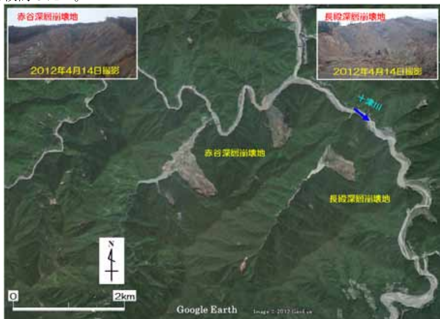
図 6.3 長殿谷流域と赤谷流域で発生した深層崩壊
