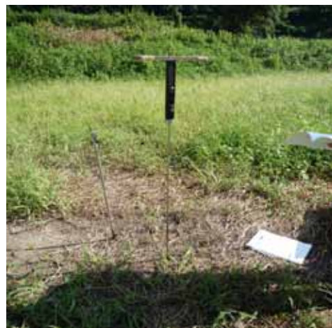
図-5 土検棒による地盤強度パラメータの推定
