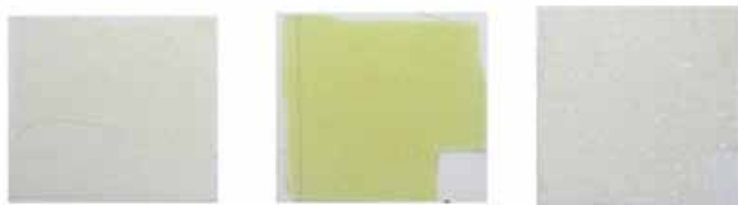
媒染なし 塩化アルミニウム(前媒染) 酒石(前媒染) 黄色色素溶液(アセトン)による染色実験
