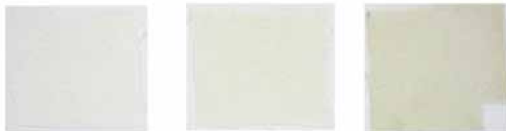
媒染なし 塩化アルミニウム(前媒染) 酒石(前媒染) 赤色素溶液(水)による染色実験
