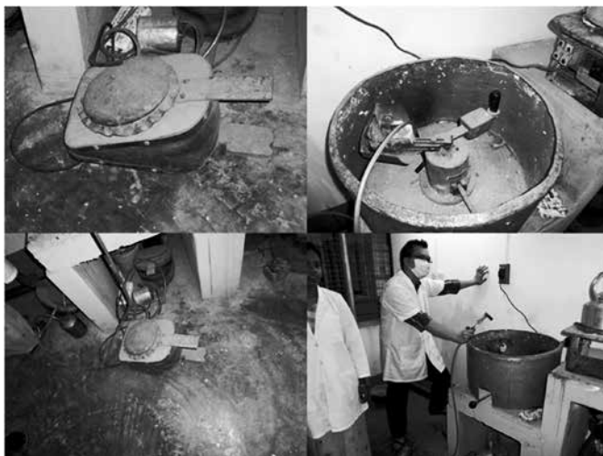
ヤンゴン歯科大学附属歯科技工士学校の設備 旧式の機械が使用されており未だにふいごを使用して鑄造している。近代化が望まれる（2013年3月）
