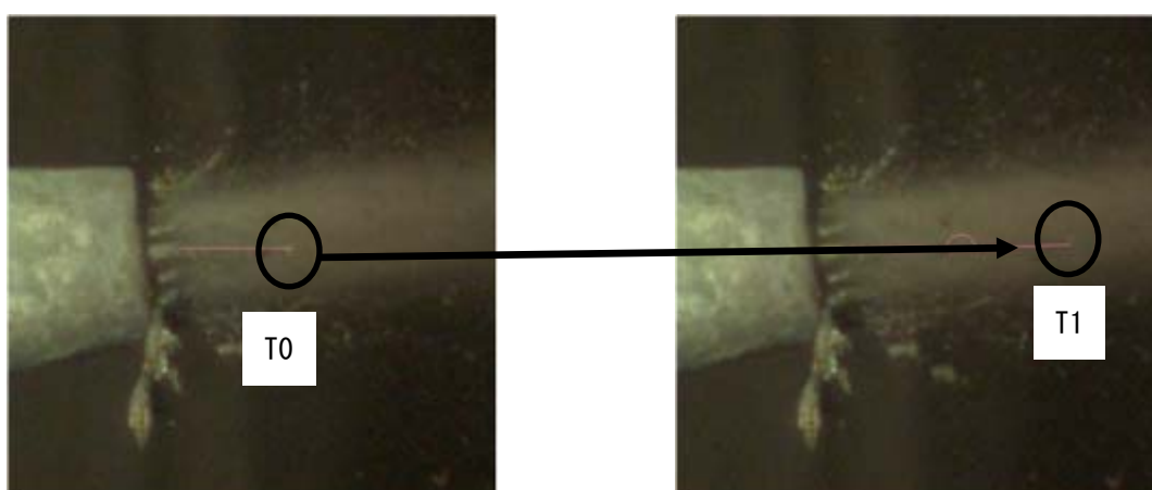
写真-4.6 連続する2時刻 T0, T1 の画像(ノズル C, ノズル中央部分)
