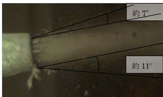
図-4.9 粒子の拡散角度(ノズル C)
