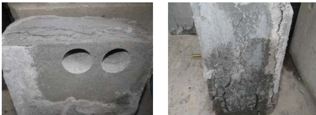
写真-7.3 屋外曝露後の供試体状況
