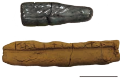
Fig. 40 陶芸家による焼成実験に使用したテストピース 施釉したもの(上)と乾燥のみの状態(下) 棒線は5 cm
