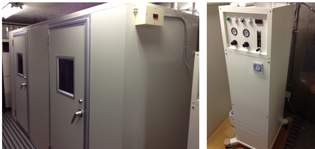
図 2-1. O_2 濃度・ CO_2 濃度同時制御チャンバー（左図）と N_2 ガス発生装置（右図）の外観写真.
