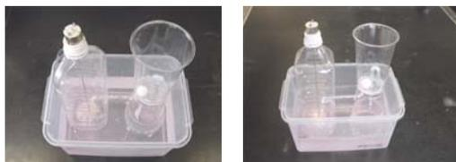
図6 曲がるストローを使ったサイフォンの原理観察装置
