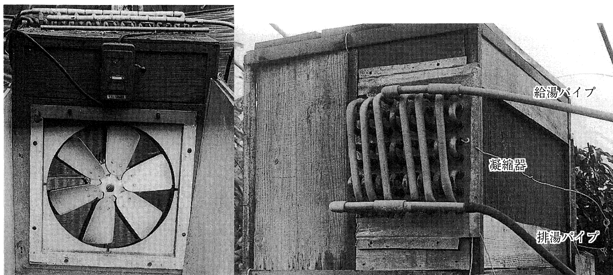
第16図. 温泉-空気熱交換器 (1号器, 左: 正面, 右: 側面).
