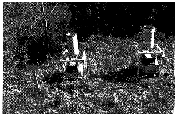
写真-4 土面川流域における雨量観測 (標高430m)
