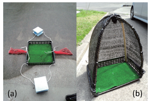
写真1. 人工産卵装置の形態。a) 衝立無；b) 衝立有。
