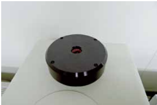
図9：顕微システムの液体窒素注入口
