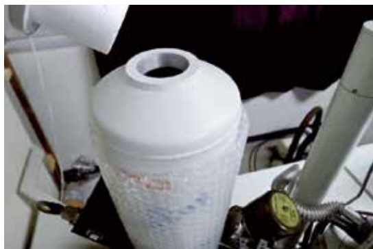
図6：エネルギー分散型蛍光X線分析器の液体窒素注入口
