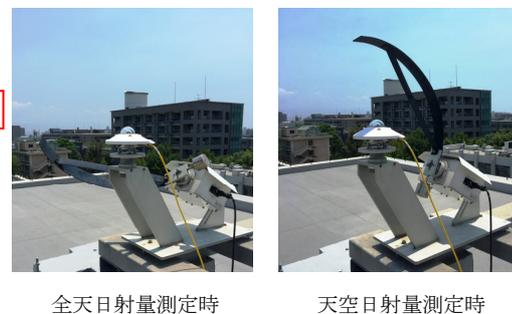
図2.2 水平面日射計の設置状況
