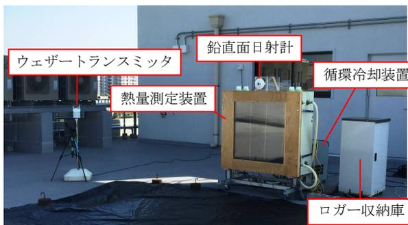
図2.1 熱量測定装置周辺の設置状況
