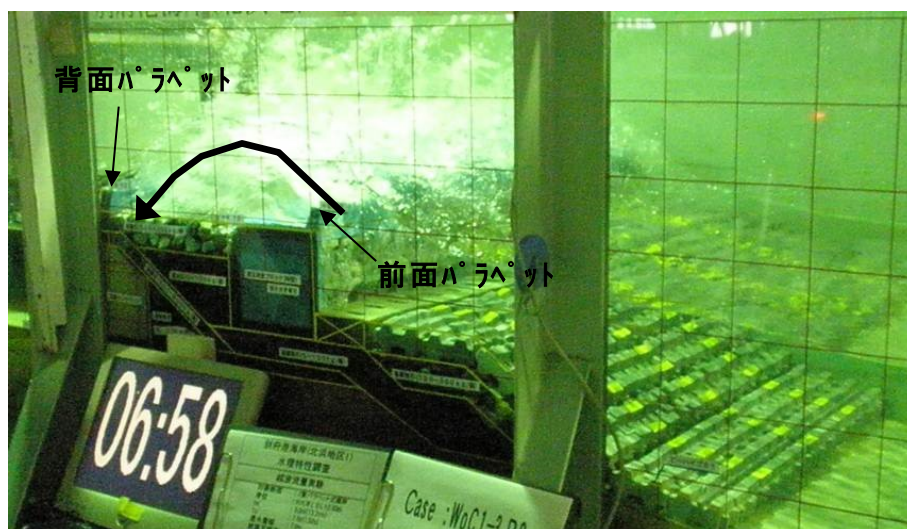
写真 5.2 越波流量の水力模型実験状況
