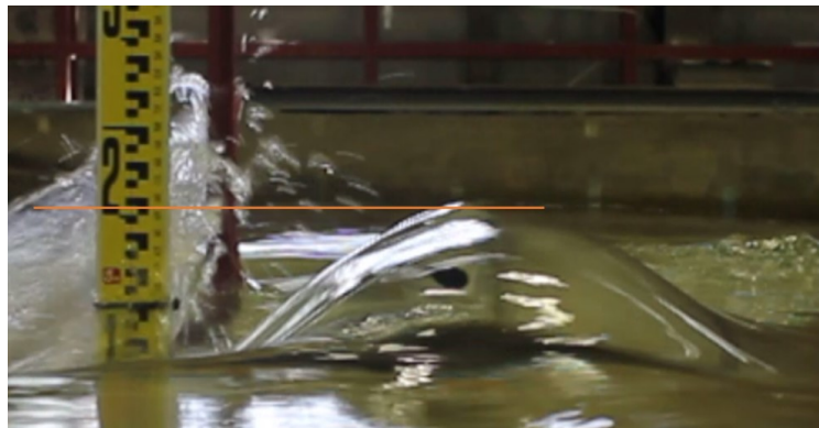
図 3.12 台形断面防波堤模型の波の越流状況
