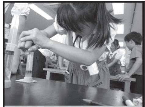
【写真1 閉じ込めた空気と水の押し返す力の再実験】
