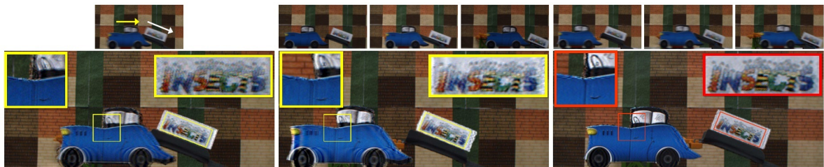
図 2.10 複数物体があるシーンでのブレ除去. 左から符号化開口, 複数露光ビデオ, 複数パターン符号化開口ビデオによるブレ除去結果
