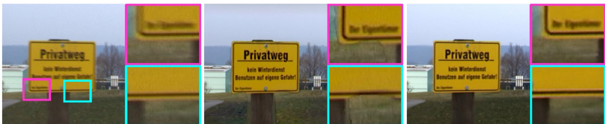
図 2.20 セグメンテーションベースの手法との比較. 左から：ブレのあるフレーム， Cho らのブレ除去結果， この手法でのブレ除去結果
