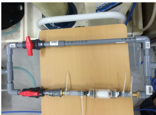
7 図1-9 使用したせん断型バブル生成装置
