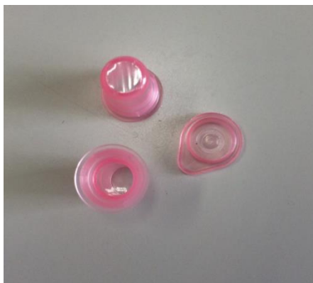
4 図 2-5 透析用半透膜セル
