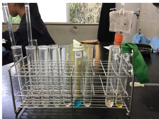
1c. 風船を利用した気体の漏出防止 (写真は頤娃中学校での実験)
