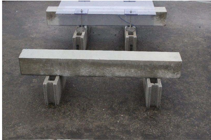
写真 4.3 降雨直後のカバー無供試体の様子
