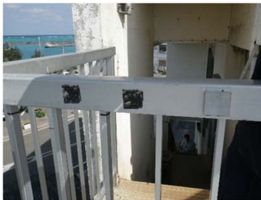
写真 3.2 薄板モルタル供試体および設置例
