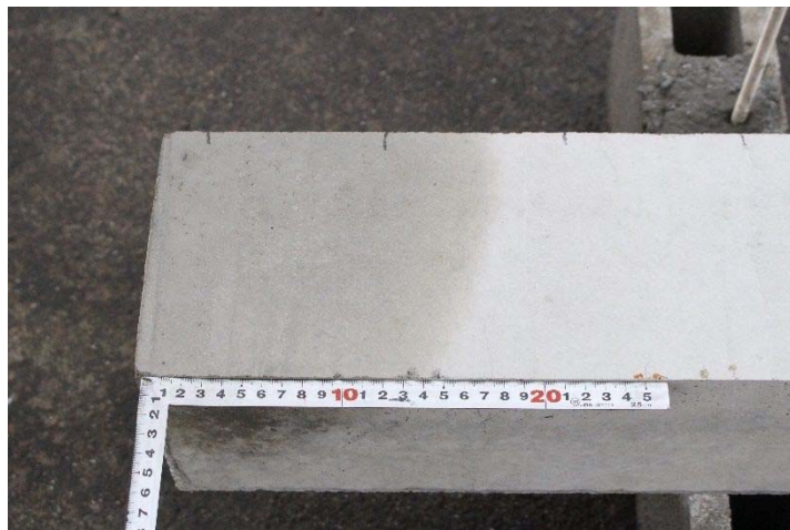
写真 4.5 降雨直後の端部露出供試体の様子
