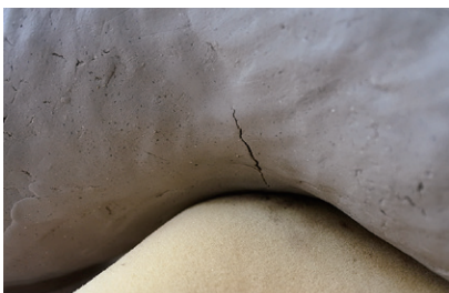
図5. 重みによる亀裂
