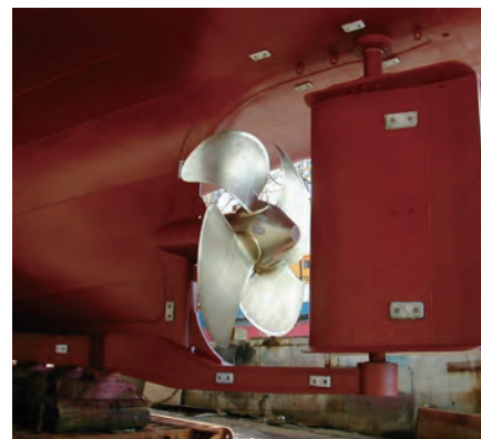
図1. 南星丸のシリング舵（断面形状が魚型と上下の端版が特徴）
