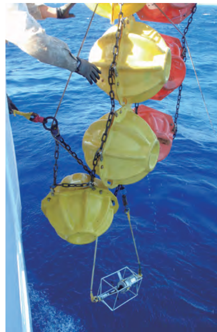
写真2 三次元超音波流速計(三次元超音波流向流速計に錘とフイをつけて保留し、海中の流れを1年間にわたって連続観測する。こういう気長な観測も行っている。)
