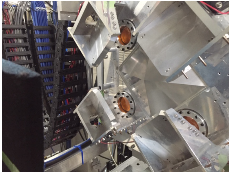
Figure 36: 野辺山 45m 鏡に搭載されている受信機 FOREST (2016 年 5 月 20 日筆者撮影)
