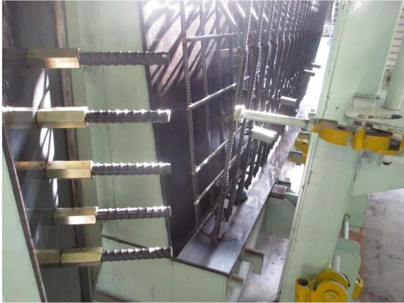
写真-5.6 横連結用のインサートのセット状況
