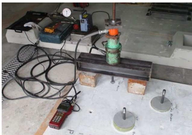
図-3.6 引抜試験の状況
