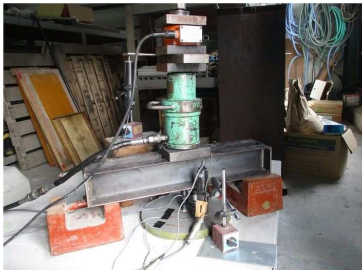
写真-3.9 引抜試験の状況
