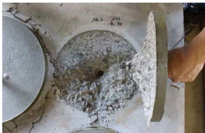
写真-3.11 供試体（No.2）のコーン破壊状況
