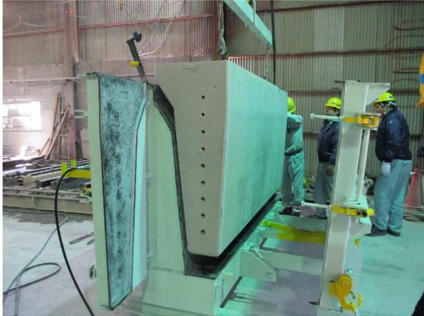
写真-5.1 プレキャスト壁高欄の鋼製型枠②
