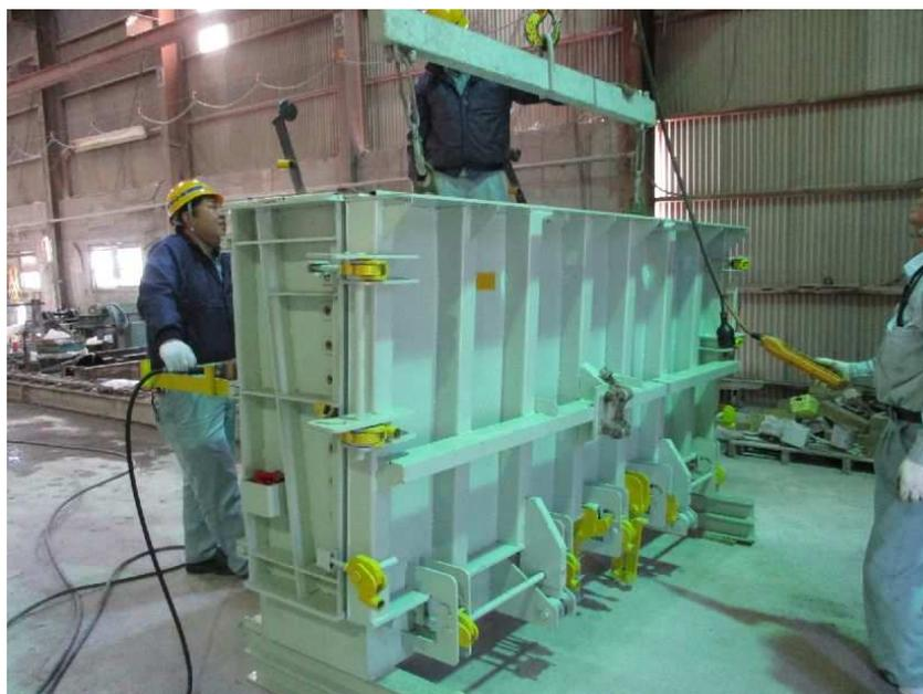
写真-5.1 プレキャスト壁高欄の鋼製型枠①
