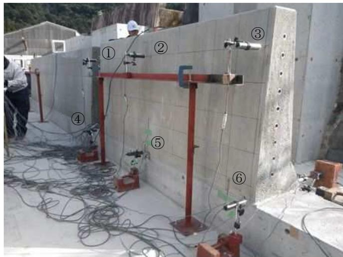
写真-6.5 変位計の設置状況
