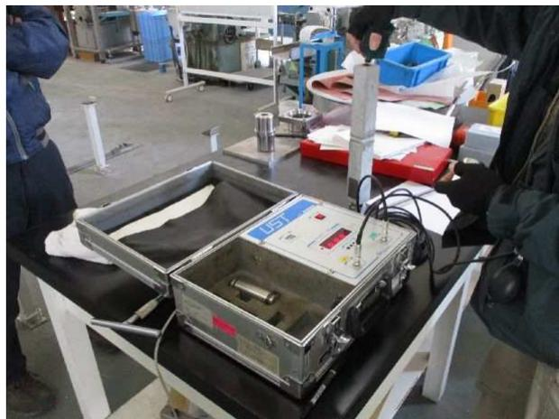
写真-2.3 伝搬速度測定状況
