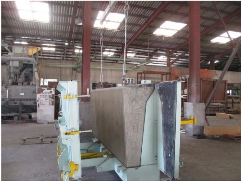
写真-5.12 型枠からの取外し作業状況
