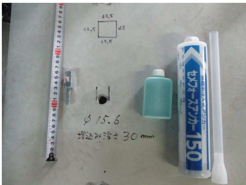
写真-3.1 引抜き試験用の穴の穿孔状況と試験材料
