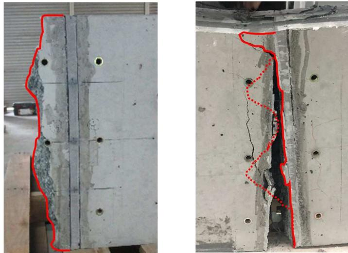
写真-4.12 左) 無疲労試験体の破壊状況，右) 疲労後の試験体の破壊状況
