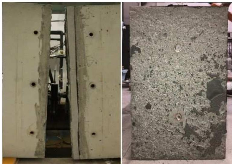
写真-4.10 供試体 C の破壊状況
