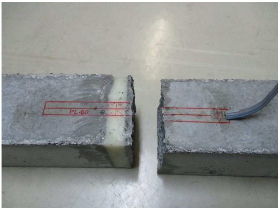
写真-2.4 エポキシ接合供試体の破断状況
