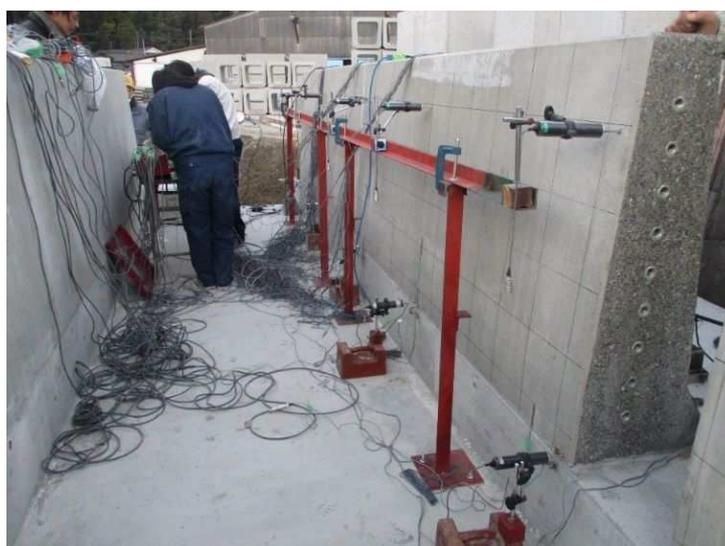
写真-6.6 変位計の設置状況
