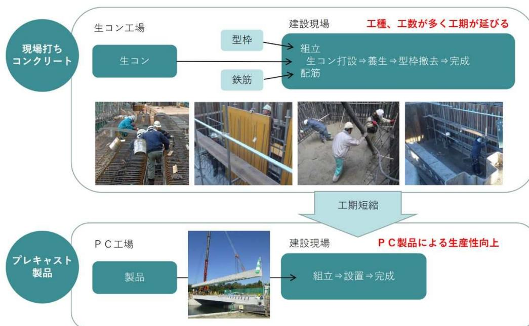
図-1.8 現場打コンクリートとプレキャスト製品の比較
