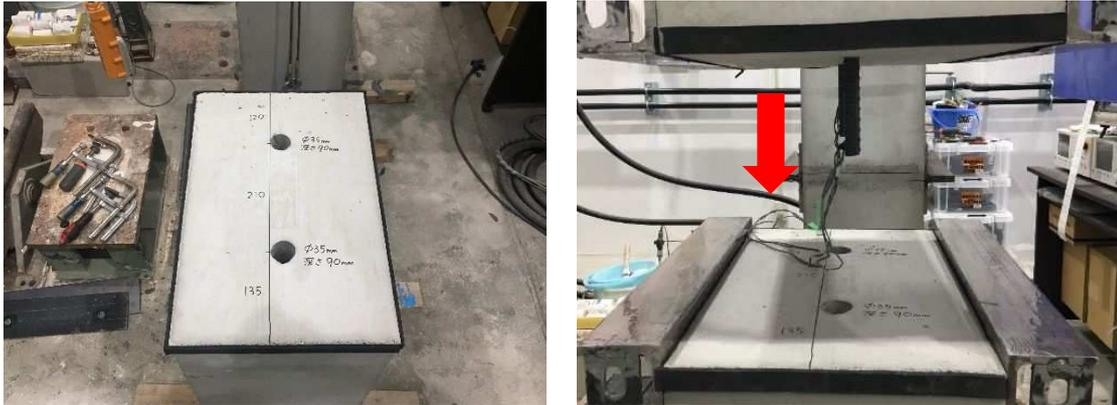
写真-4.4 供試体の接合状況（左：穿孔部の状況，右：接合状況）
