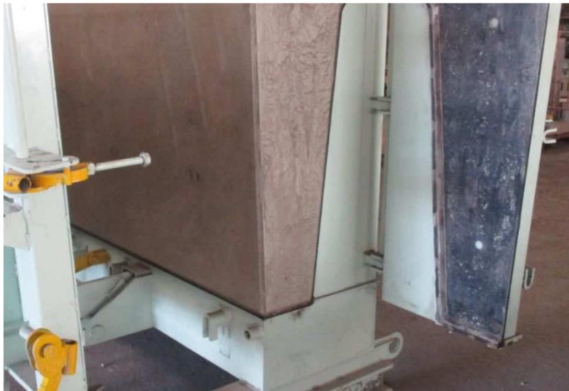
写真-5.3 プレキャスト壁高欄の面取り状況
