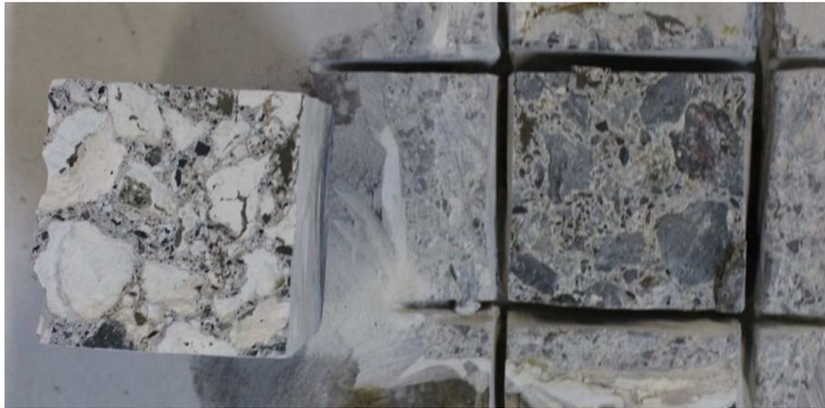
写真-2.9 引抜試験後の破断面の状況
