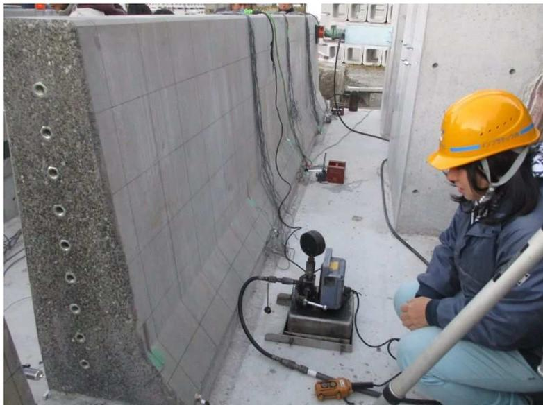
写真-6.2 静的載荷試験の試験状況（正面側）
