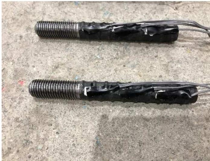
写真-4.3 供試体に用いたアンカー筋 (床版側 D16)
