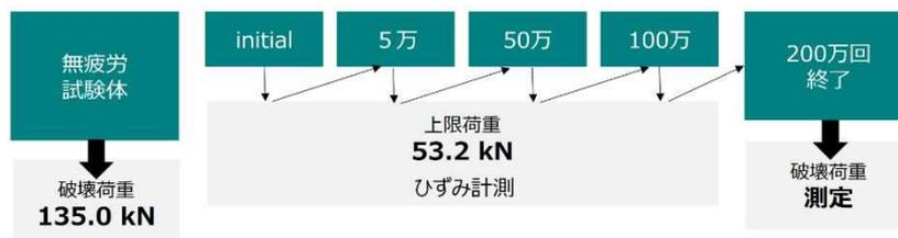
図-4.11 繰返し荷重試験の概要
