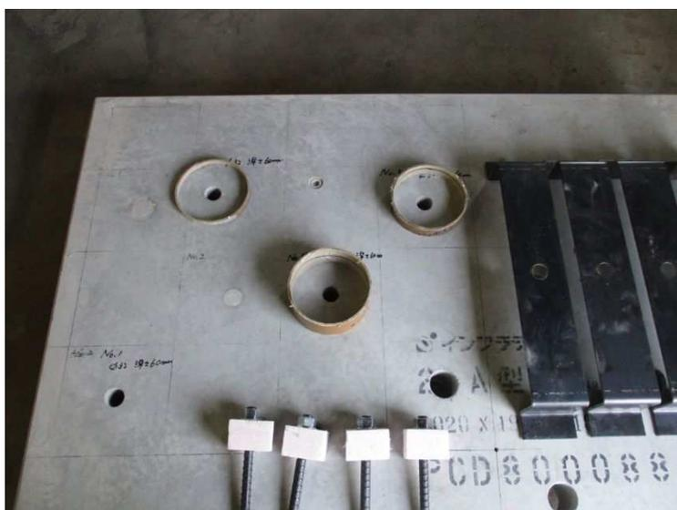
写真-3.7 供試体の製作状況（アンカー筋設置前）
