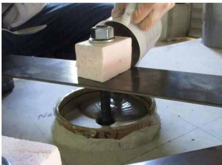
写真-3.8 エポキシモルタルの充填状況
