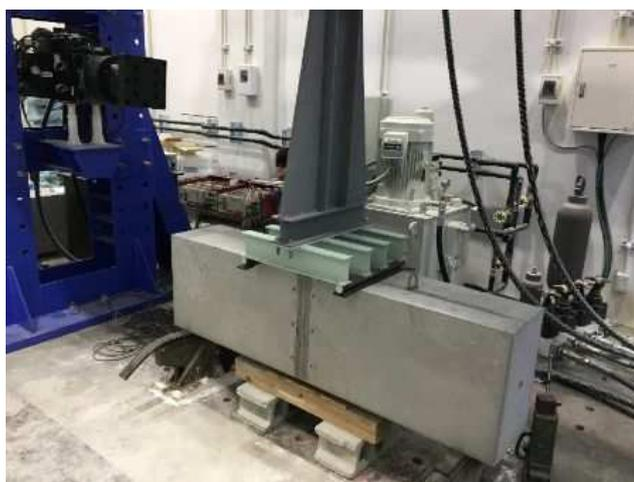
写真-4.11 繰返し荷重試験の状況
