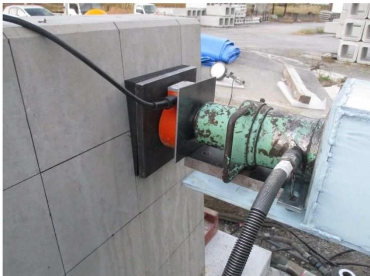
写真-6.1 静的載荷試験の載荷部の状況
