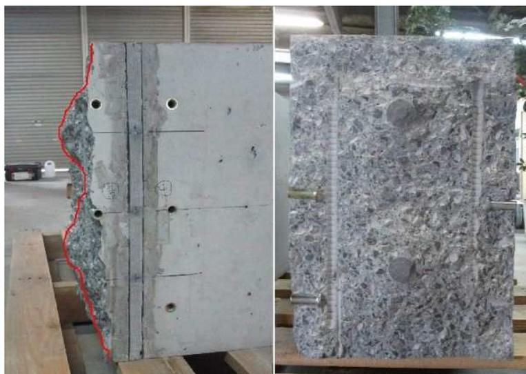
写真-4.8 供試体 A の破壊状況
