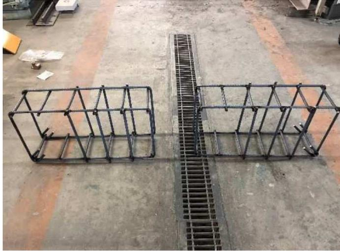
写真-4.1 供試体に用いた鉄筋 (D13)
