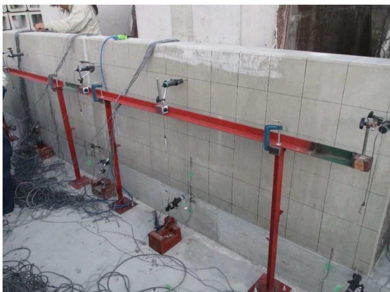
写真-6.3 静的載荷試験の試験状況（背面側）
