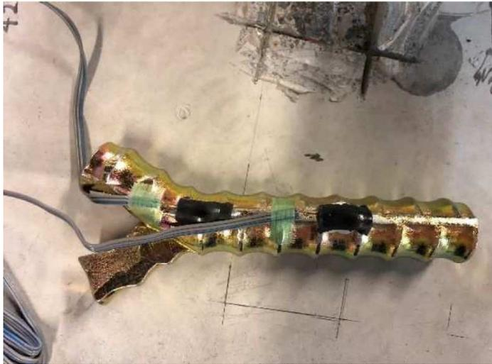
写真-4.2 供試体に用いたインサート (プレキャスト壁高欄側)
