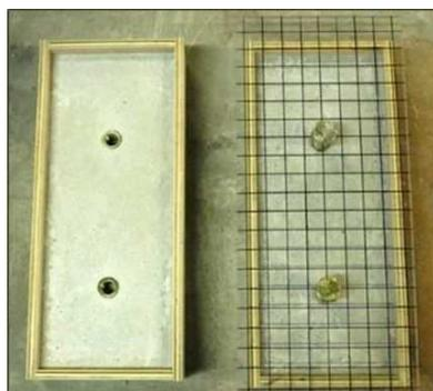
写真-2.12 充填性能試験用の供試体状況
