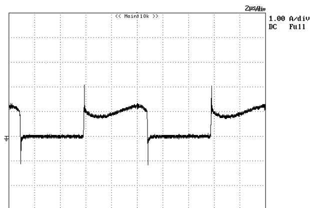
図 5-6 L' = 105[\mu\text{H}] のときの 2 次側ダイオード電流の波形
