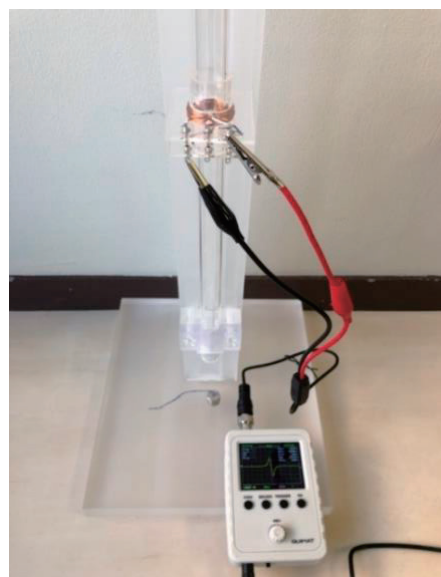
図2 試作した実験キット コイルにオシロスコープを接続
