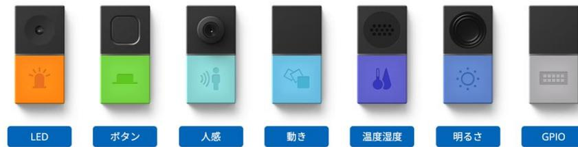
図 1 MESH のセンサーブロック
