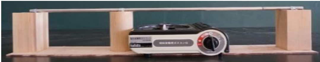
写真3 金属のレールをアルミニウム棒で再現した教材
