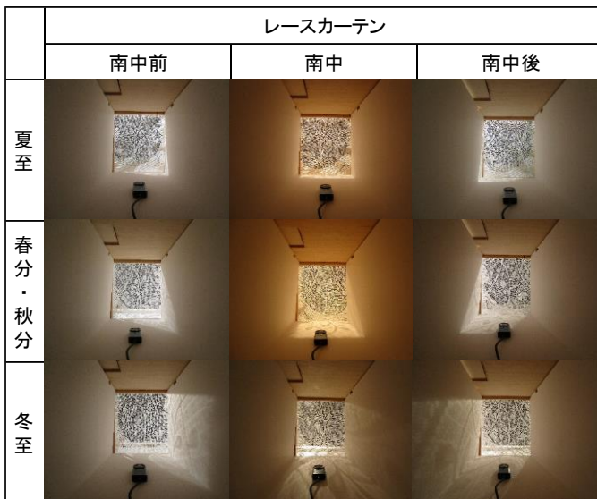
写真 4.16 各季節の南中時と南中前後の日射遮へい状況 【レースカーテン設置時】
