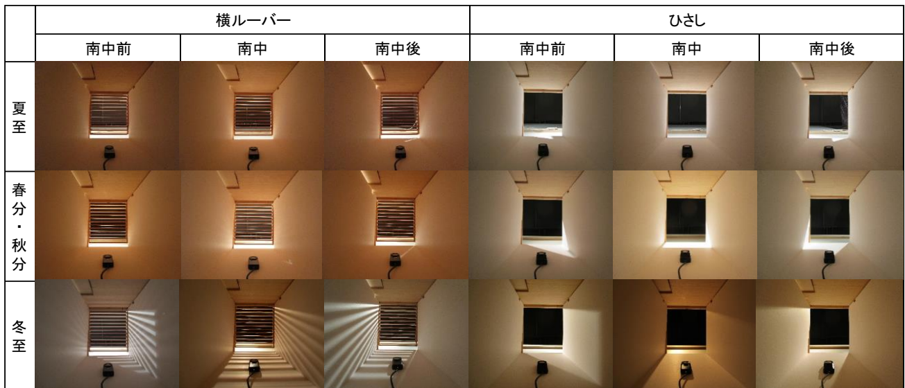
写真 4.14 各季節の南中時と南中前後の日射遮へい状況 【横ルーバーとひさし設置時】
