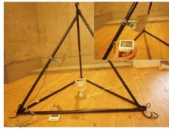
図1 シェルターモデルのフレーム、及びランプ・温度計の設置状況
