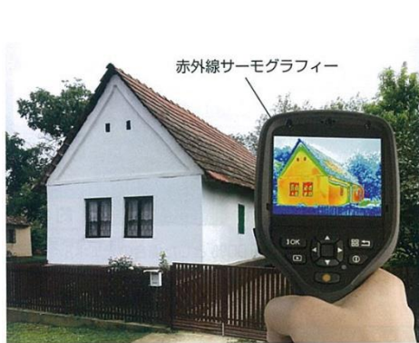
赤外線サーモグラフィは、物体から出る赤外線をもとに、物体の表面の温度を色で表すことができる。写真の画像では、青っぽい色より赤っぽい色の方が温度が高い。
