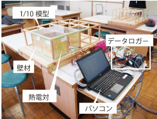
写真 5.7 1/10 模型と断熱実験装置
