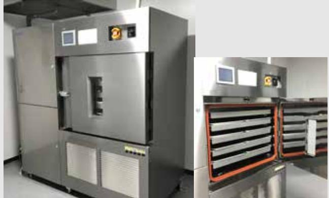
図2-2-8 真空膨化乾燥装置
