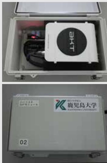
図 2-2-19 新たに製作した高精度位置計測モジュール
