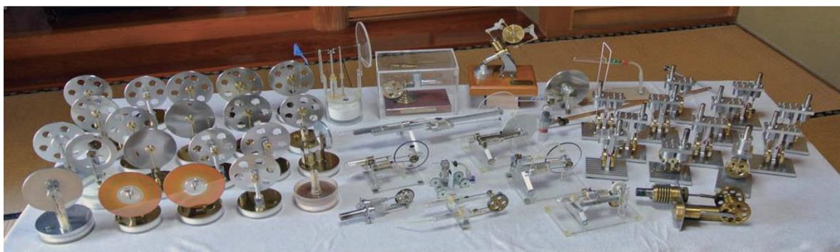
写真3. 製作した教材用スターリングエンジンの内の約50機
