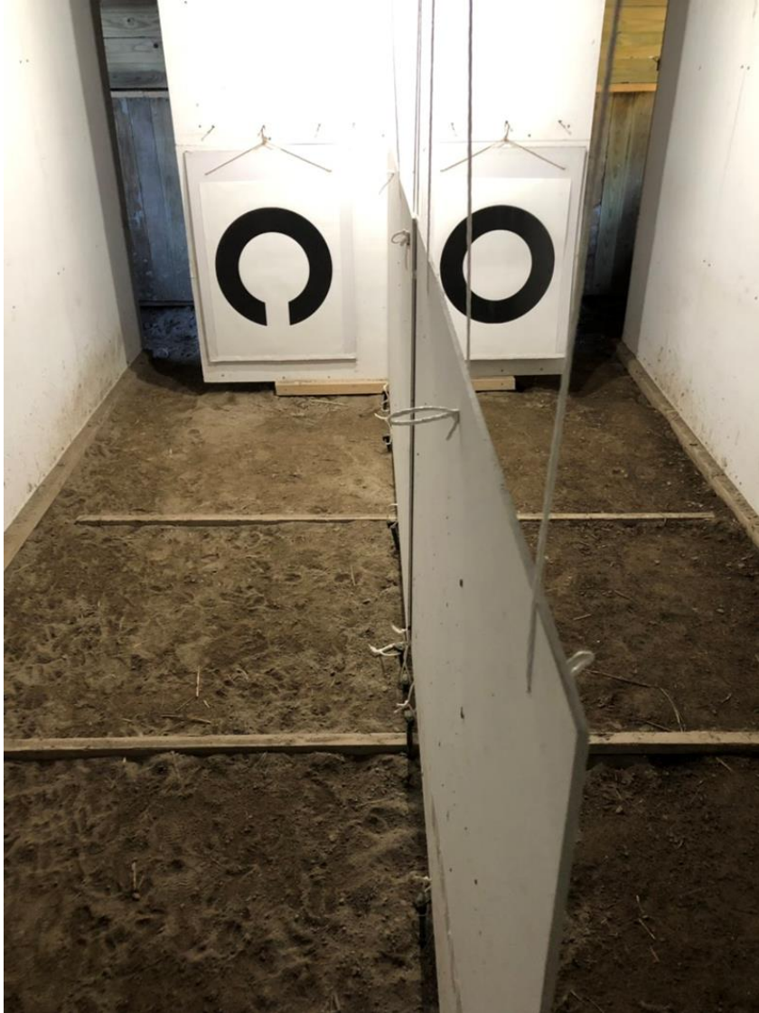
図 4-14. 衝立前方左右の 2 枚の視力パネル（視力 0.01）と衝立の中心から待機室に向かって設けた 300 cm の中央仕切り
