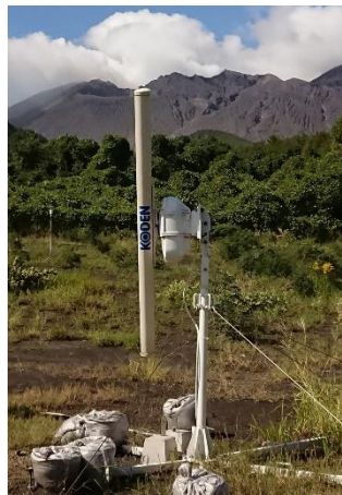
図 2-3. X-MRN による噴煙観測。アンテナを 90° 倒して RHI 観測する。
