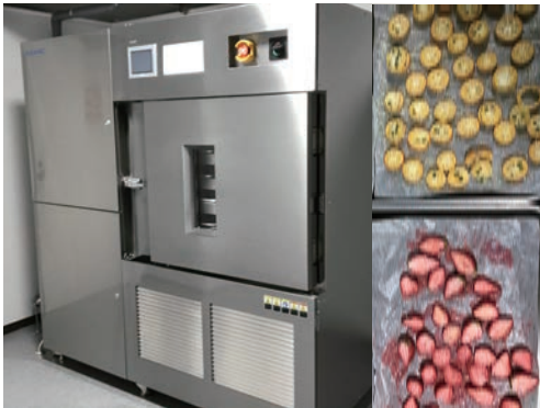
図4-4 真空膨化乾燥装置（左）とフルーツ乾燥品（右）
