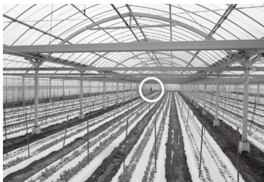
図2：ケーブルカメラシステムを設置したトルコキキョウ温室。円内中央にカメラを搭載した本体が見える。
