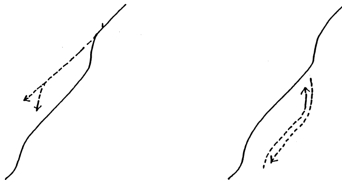
第13図 破碎帯の形状 分岐・結合する断層の例
