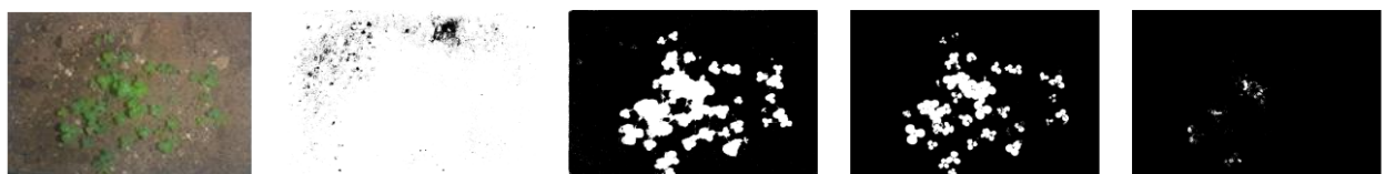
(a) 可視光画像 (b) 二値画像 ( t=-0.10 ) (c) 二値画像 ( t=0.00 ) (d) 二値画像 ( t=0.10 ) (e) 二値画像 ( t=0.20 )
