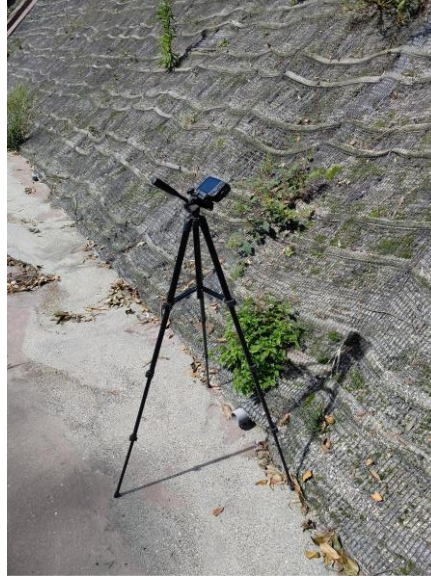
写真3-6 調査対象法面におけるデジタルカメラによる画像の撮影状況
