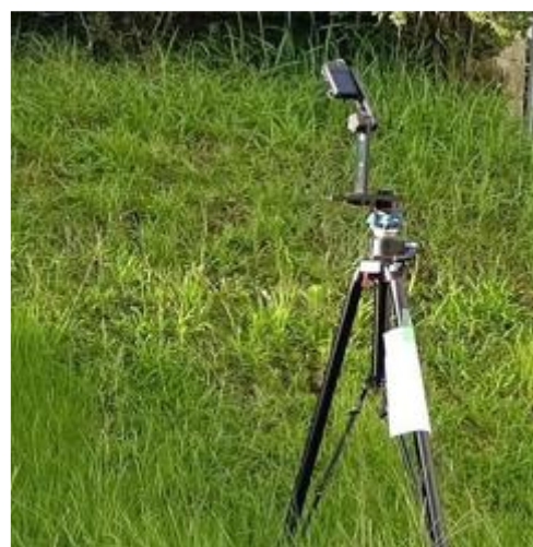
写真3-1 植生法面の定点撮影状況
