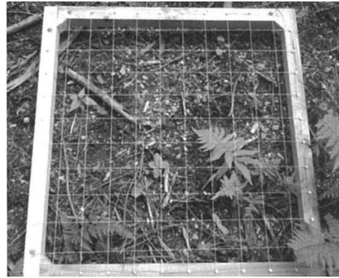
写真2-2 ポイントカウンティング法による植被率の計測状況 18)
