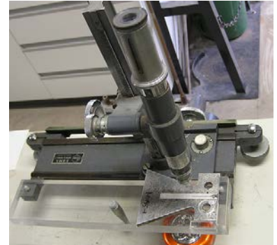
図 4.ステージに透光性を持たせた読み取り顕微鏡
