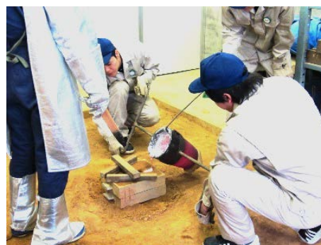
図6 鋳込みの様子
