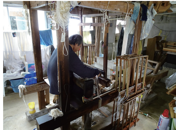
写真1 宮古上布で利用されている締機
