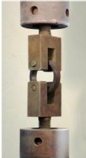
図2-3. 試験片設置時の外観
