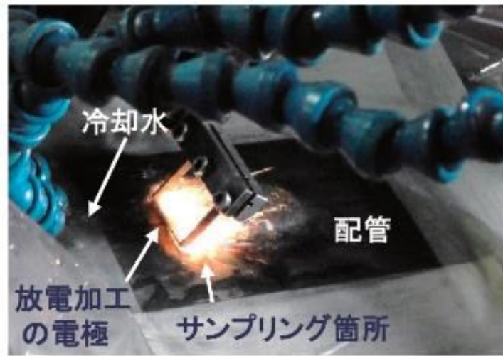
図1-3 微小サンプル試験片の採取
